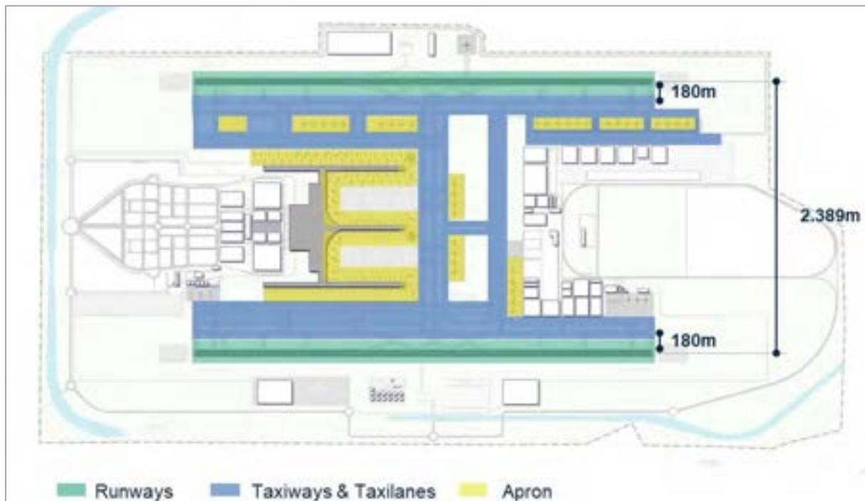
Figura 88: Dimensões principais do aeródromo.
